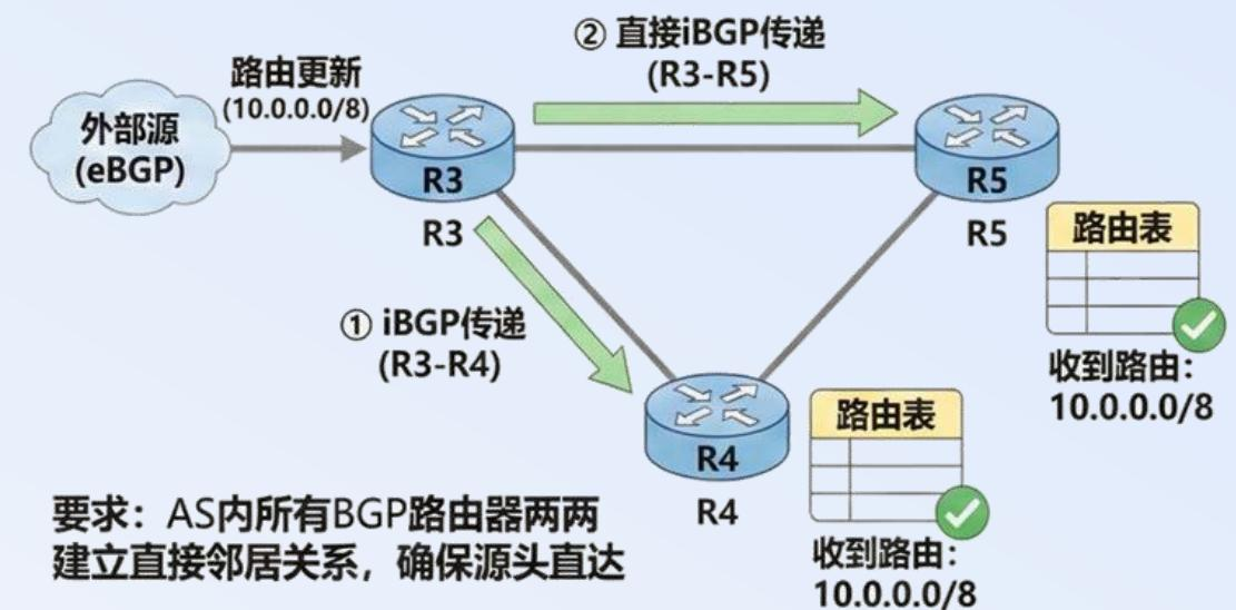
此时水平方向路由传递会中断，因此在AS内部，我们需要所有运行BGP的路由器都建立**全互联关系**，即两两建立邻居关系，以确保都能从源头收到路由更新。现实网络中两两组合开销巨大，维护困难，因此会引入路由反射器作为特权打破者，允许其将从iBGP邻居学到的路由转发给其他邻居，路由器只需要和路由反射器建立邻居关系。
